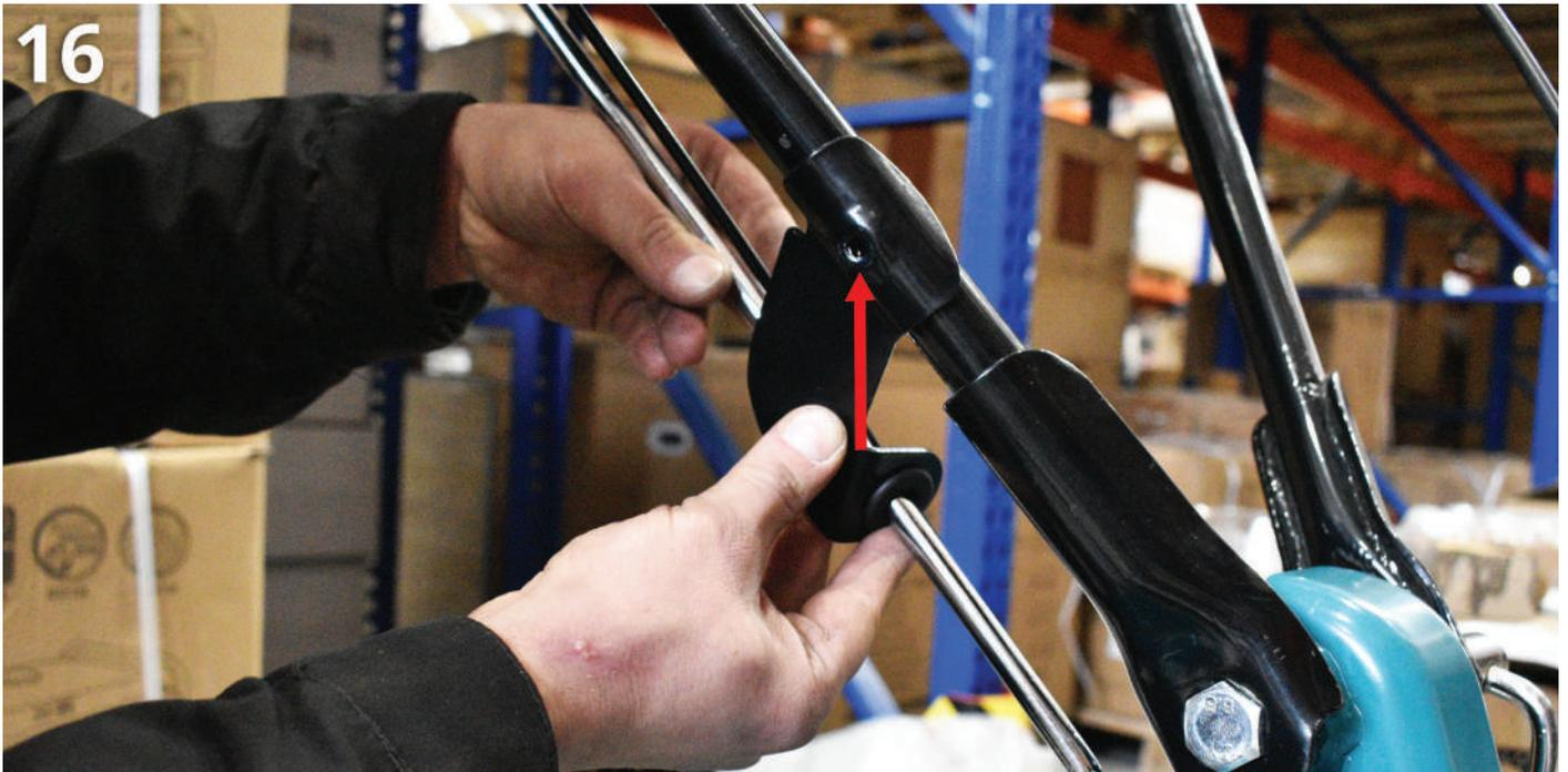
Fig. 17. Attach the shift lever to the stem.
